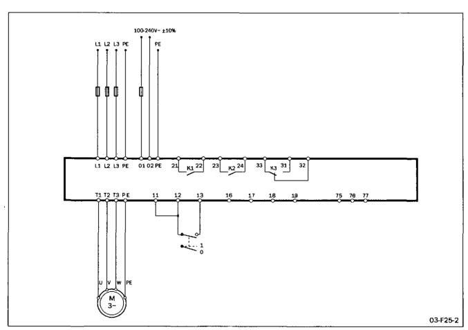
Fig. 24 Wiring circuit, "minimum wiring".
