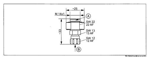
Abb. 14: Test adapter
